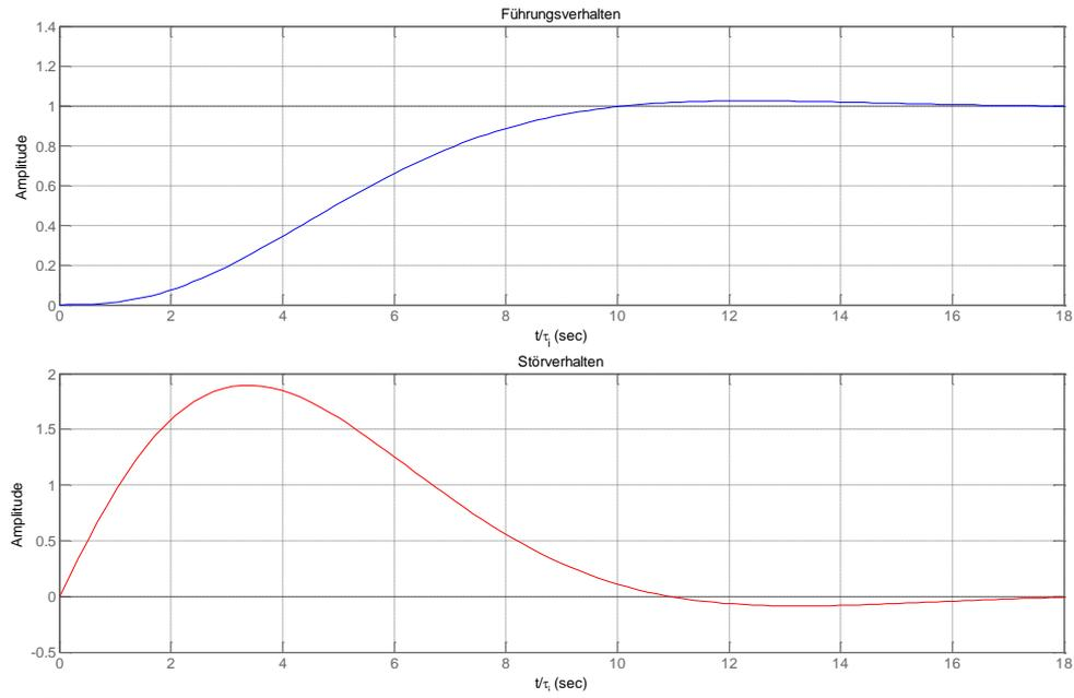
**Fig. 6-19:** Antworten der Ausgangsspannung auf Führungs- (blau) und Störsprung (rot) mit Führungsgrößenvorfilter
