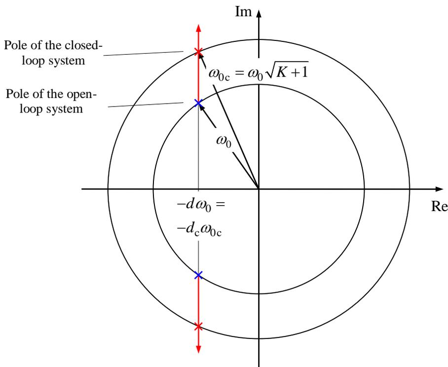
**Fig. 6-9:** Verschiebung der Polstellen durch einen  $P$ -Regler Displacement of the poles by a  $P$ -controller
