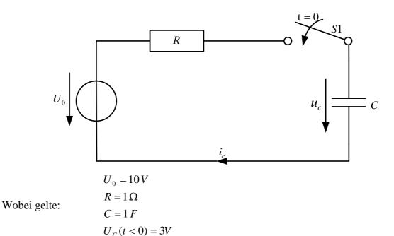
Zum Zeitpunkt t = 0 wird der Schalter S1 geschlossen. Die Spannung am Kondensator C betrage vor dem Schaltvorgang 3V.
