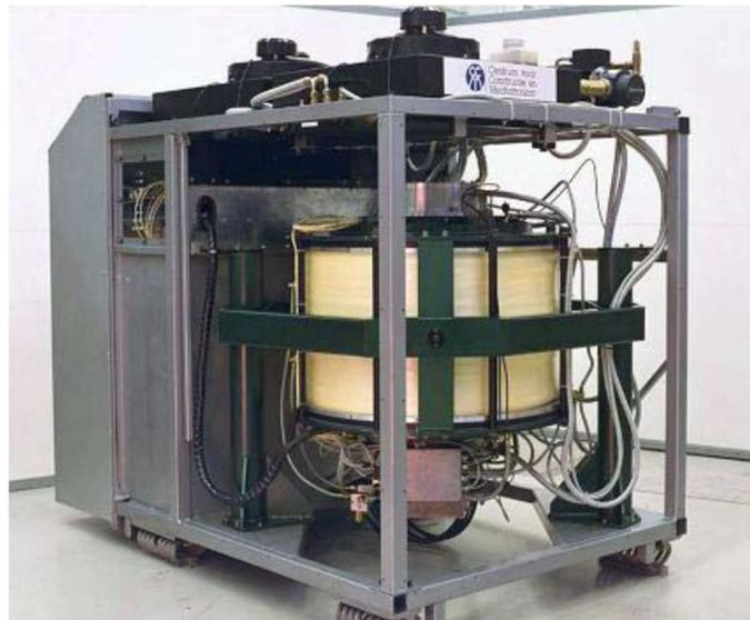
**Bild 7-20:** Karbonschwungrad der Firma Emafer für ein prototypisches Schienenfahrzeug mit Energiespeicher: 375 kg; 4 kWh = 14,4 MJ; 300 kW (Quelle: Emafer)
