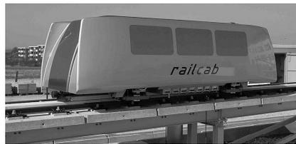
RailCab Versuchsfahrzeug (Maßstab 1:2.5)
