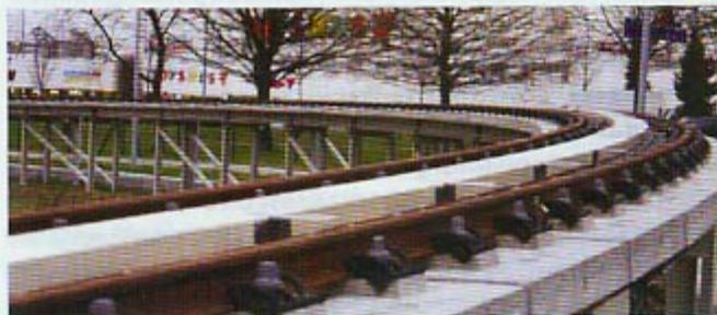
Bild 10: Aufgeständerter Gleisabschnitt mit Langstator.
