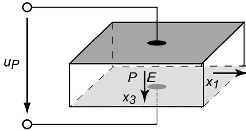
Fig. 1: Basic piezoelectric actuator
