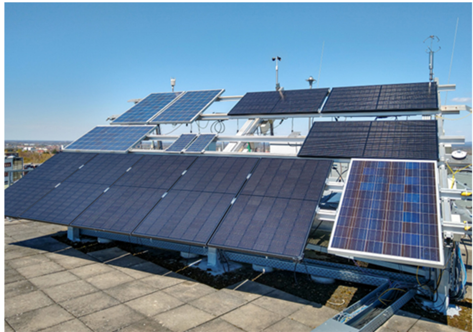
Abbildung 4. Anordnung der PV-Module des PV-Freilandlabors im Jahr 2023 für den Vergleich der elektrischen Energieerträge von Mikro-Wechselrichtern unter Verwendung von acht bis zehn gleichen, kalibrierten PV-Modulen (mit je 360 W p ) als Eingänge.
