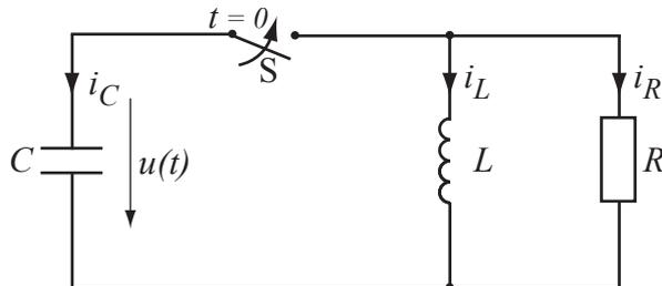
1. Stellen Sie die Differenzialgleichung für  $t \geq 0$  für die Spannung  $u(t)$  auf.
