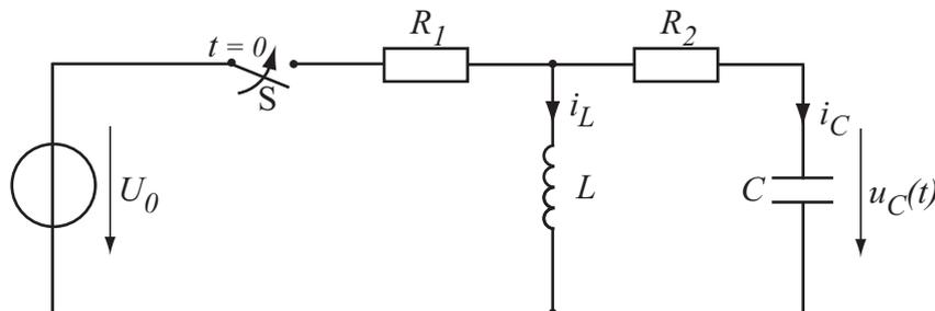
1. Stellen Sie die Differenzialgleichung für  $t \geq 0$  für die Spannung  $u(t)$  auf.
