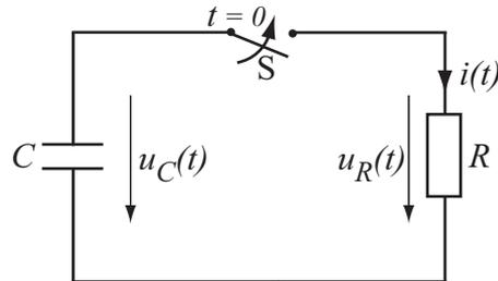
Zum Zeitpunkt  $t = 0$  werde der Schalter  $S$  geschlossen. Vor diesem Zeitpunkt sei der Kondensator  $C$  auf die Spannung  $U_{C0}$  aufgeladen.
