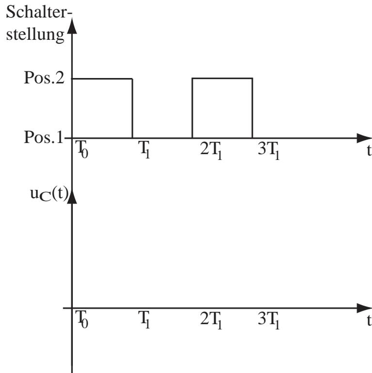
4. Skizzieren Sie den Spannungsverlauf am Kondensator  $u_C(t)$  in dem obigen Koordinatensystem. Geben Sie die Spannungen an, die zu den Zeitpunkten  $T_1$ ,  $2T_1$  und  $3T_1$  am Kondensator anliegen.
