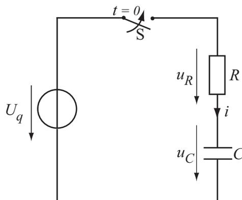
Zum Zeitpunkt  $t = 0$  werde der Schalter geschlossen und der Kondensator  $C$  über den Widerstand  $R$  geladen. Für die Spannung am Kondensator  $u_C$  gilt für die Zeit  $t < 0$ :  $u_C(t) = 0\text{V}$ .
