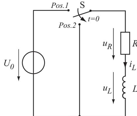
Vor dem Zeitpunkt  $t = 0$  befinde sich die Schaltung im stationären Zustand. Zum Zeitpunkt  $t = 0$  wird der ideale Schalter von Position 1 in Position 2 geschaltet.
