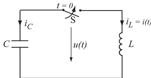
1. Stellen Sie die Differenzialgleichung für  $t \geq 0$  für die Spannung  $u(t)$  auf.
