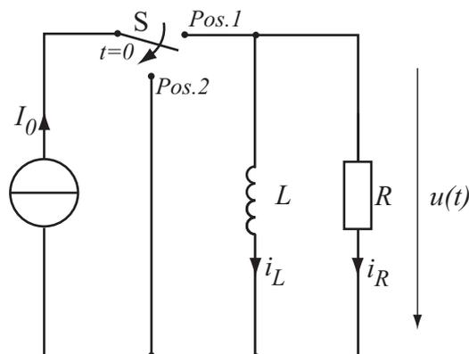
Zum Zeitpunkt  $t = 0$  wird der Schalter von Position 1 in Position 2 geschaltet. Vor diesem Zeitpunkt sei die Schaltung im stationären (eingeschwungenen) Zustand. Weiterhin betrage der Quellstrom der idealen Stromquelle  $I_0 = 12 \text{ A}$ .
