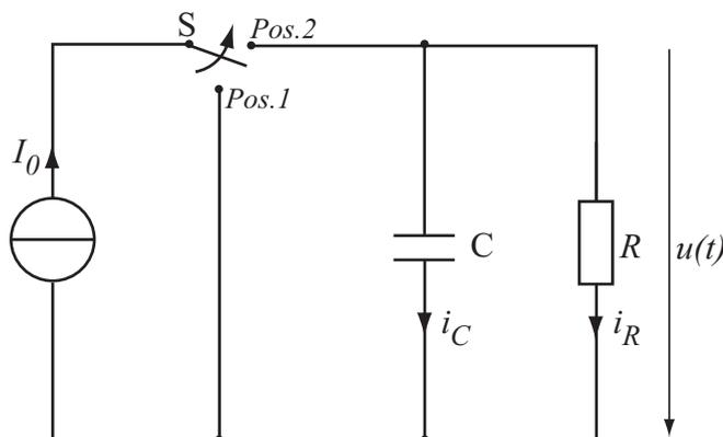
Zum Zeitpunkt  $t = 0$  werde der Schalter  $S$  von Position 1 in Position 2 geschaltet. Der Kondensator ist zu diesem Zeitpunkt entladen, d.h. für  $t \leq 0$  s gelte  $u_C(t) = 0\text{V}$ :
