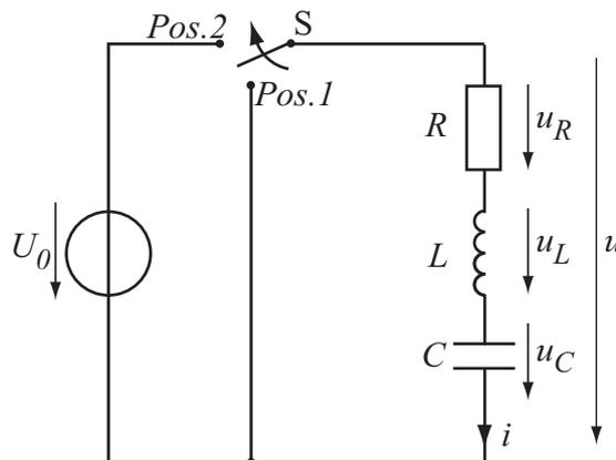
Zum Zeitpunkt  $t = 0$  werde der Schalter  $S$  von Position 1 in Position 2 geschaltet. Für  $t \leq 0$  gelte:  $u_C(t) = 0$  und  $i(t) = 0$ .
