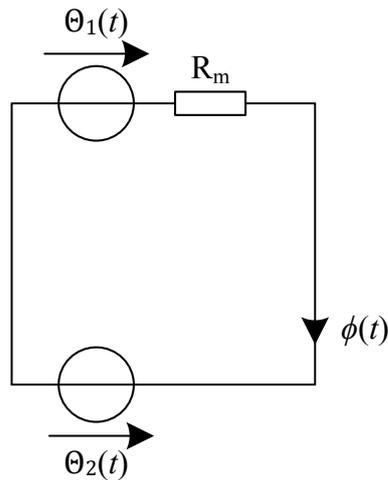
Abbildung 5.2: Gefordertes Reluktanzmodell
