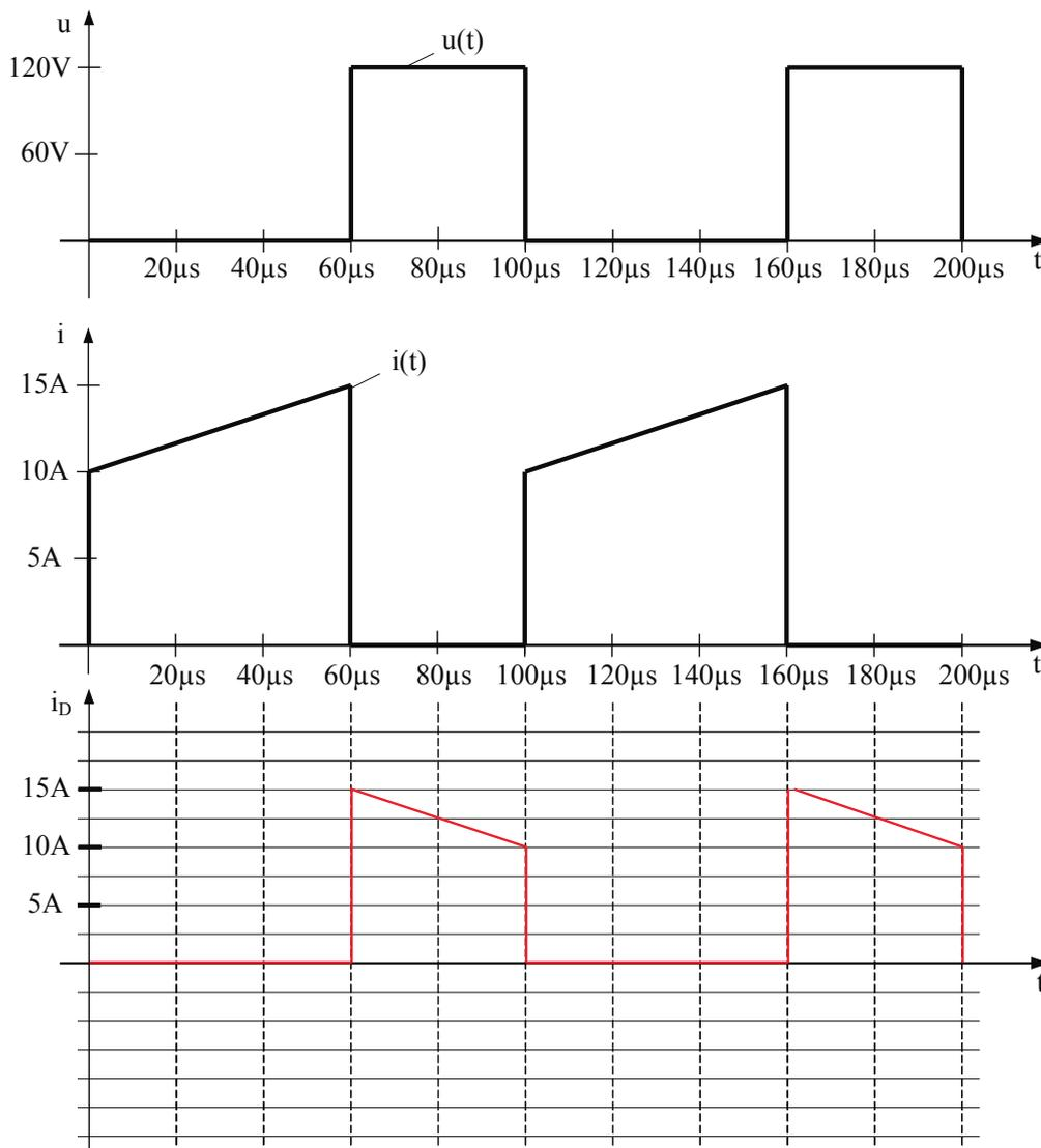
Abbildung 2.1: Stromverlauf durch Diode
