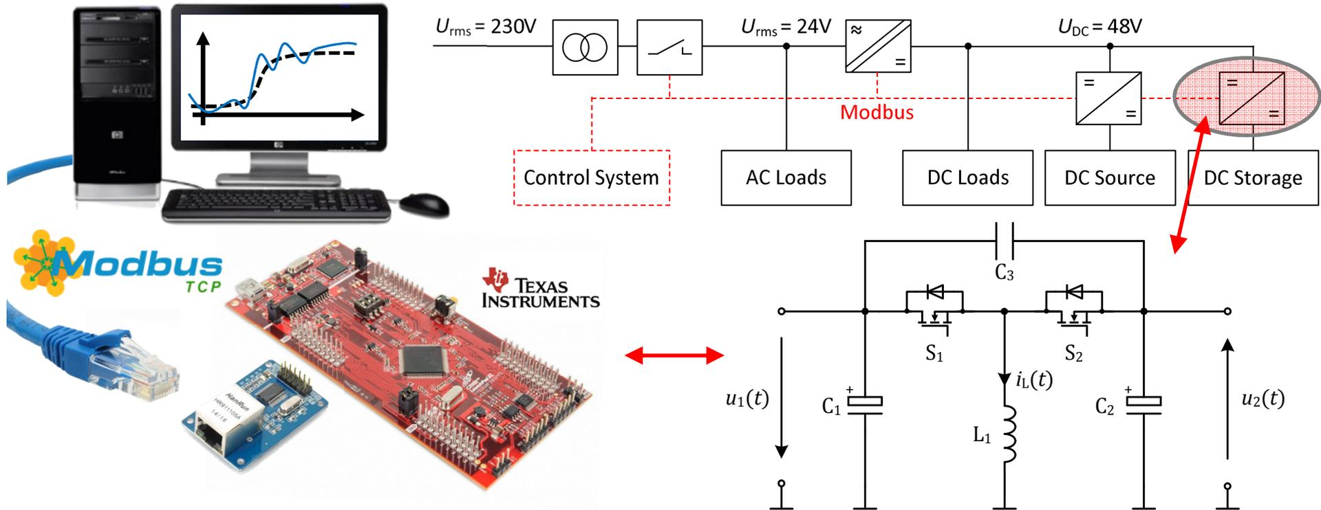
**Entwicklung und Inbetriebnahme eines bidirektionalen DC-DC Wandlers mit MODBUS-TCP Interface zur Anwendung in DC-Microgrids**
